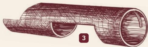
**Verbindungsrohr 3** - dabei handelt es sich um ein kleineres geformtes Rohr mit einer Aussparung für den **a** -Verschluss, der das Rohr in der richtigen Position fixiert. Dadurch kann das Rohr jederzeit entfernt werden, ohne den Smokemeister zerlegen zu müssen.
