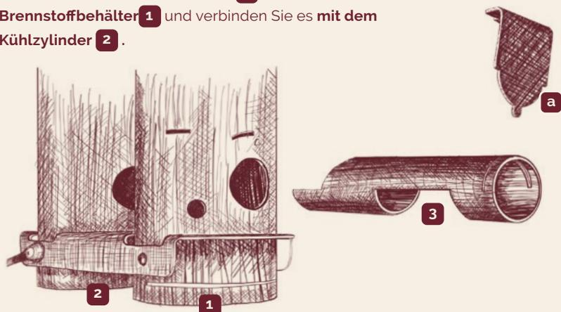
Bevor Sie das Rohr vollständig in den Zylinder einschieben, setzen Sie den **a -Verschluss** in die vorbereitete Nut des Verbindungsrohrs ein und schieben Sie dann das Rohr zusammen mit dem Verschluss bis zum Anschlag ein, sodass der Verschluss in die kleinere Nut des Kühlzylinders einrastet. Drehen Sie anschließend das Rohr leicht, **um es zu fixieren**.
